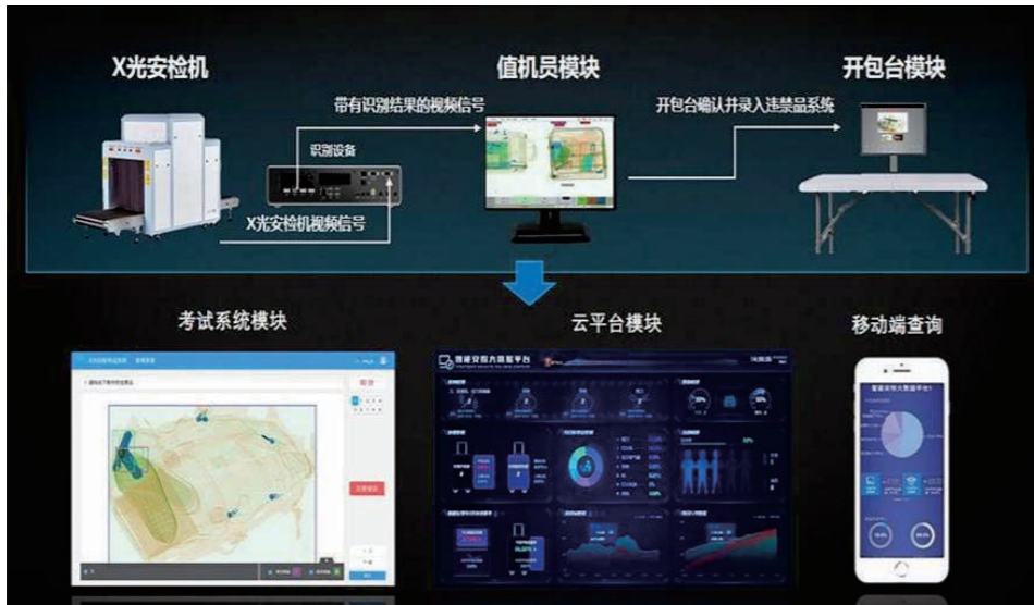
图1 X光安检图像智能识别系统组成
